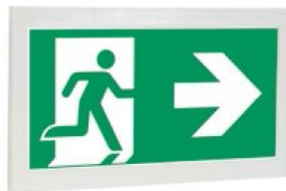
Evakuācijas norādes, 36x226x134 (184mm); 2-3W; 20m-30m
